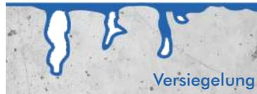
**Versiegelungen** bilden einen Schutzfilm auf der Oberfläche. Zwischen mineralischem Untergrund und der Verschmutzung entsteht eine Trennschicht.
