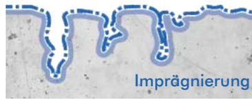
**Imprägnierungen** penetrieren in die Kapillare und benetzen die Poreinnenwände. Sie bilden einen dünnen Film an der Oberfläche, die diffusionsoffen bleibt.
