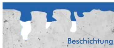
**Beschichtungen** werden in der Regel als Nutzschrift aufgebracht. Die Schichtstärke beträgt  $\geq 0,5$  mm und besteht aus 2-K Reaktionsharz.
