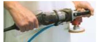
Alle Maschinen sind mit einem praktischen und flexiblen Spritzschutz ausgestattet. Vorteil: Weniger Feuchtigkeit und Schmutz gelangt in die Maschine.
