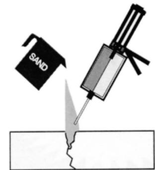
Sofort Sand einstreuen und mehr CONCRETE MENDER™ eingießen. Genug Material einfügen, damit der Spalt etwas überfüllt wird. Genügend Flüssigkeit verwenden, um den Sand vollkommen zu durchtränken.
