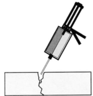
Bei Rissen und Fugen tiefer als 15 mm, vorher mit CONCRETE MENDER™ befeuchten.
